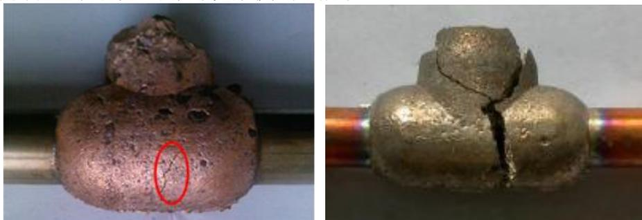
图3 接头表面裂纹
