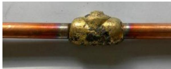
图2 接头表面熔渣
