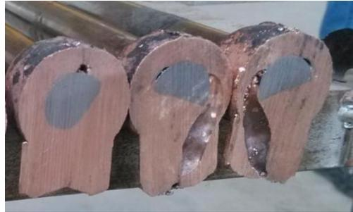
图 4 接头内部未熔合
