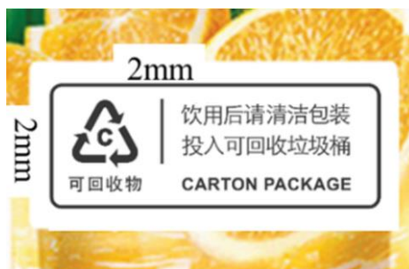
图A.2 饮料纸基复合包装回收标识的放置与背景色处理
