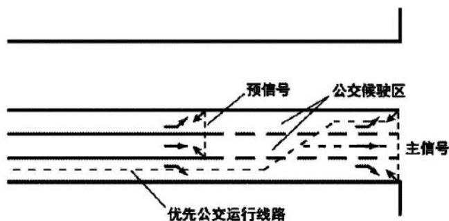
图 9 基于预信号的主动式公交信号优先控制进口道布局方案图
